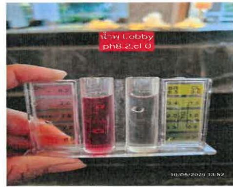
ภาพที่ 3.5.4-2 การตรวจวัด pH, Cl 2 สระว่ายน้ำ
